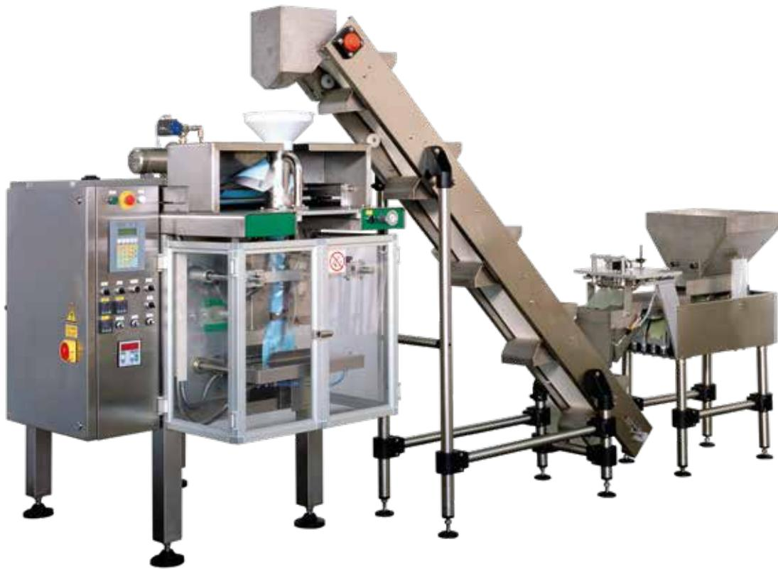
La confezionatrice VS-600 è una macchina automatica a movimento intermittente per la confezione a cuscino di prodotti sfusi in genere. Disponibile con vari sistemi di dosatura: con pesatura a canali vibranti o tappeti; con dosatori volumetrici; con dosatori a coclea per prodotti polverosi; con nastro di caricoprodotto. A richiesta possono essere sviluppate linee di confezionamento complete.
